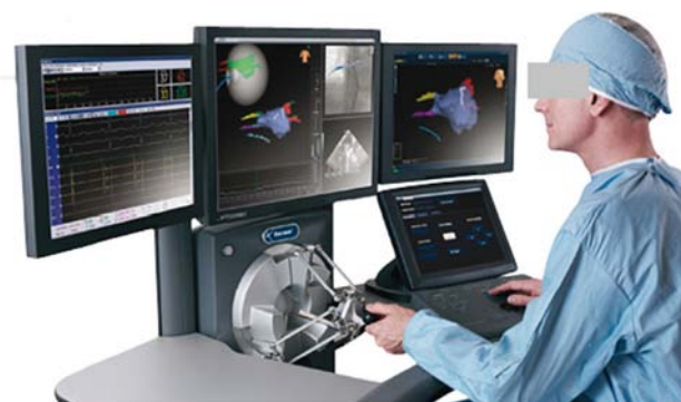
Figura 3 Control del brazo robótico del sistema Sensei ® y extremo distal del catéter Artisan ® Reproducción de Hansen® Medical.
