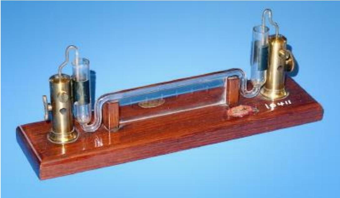
*Figura 2 Electrómetro modificado por Waller Una pequeña gota de mercurio ubicada dentro de un tubo capilar horizontal se movía bajo la influencia de un campo eléctrico aplicado por dos electrodos. El dispositivo contaba con una escala grabada en vidrio para proyección.*
