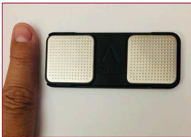
**Fig. 1.** Dispositivo portátil para registro de una derivación electrocardiográfica de contacto simple Kardia Mobile (AliveCor Inc., San Francisco, CA, EE.UU.)
